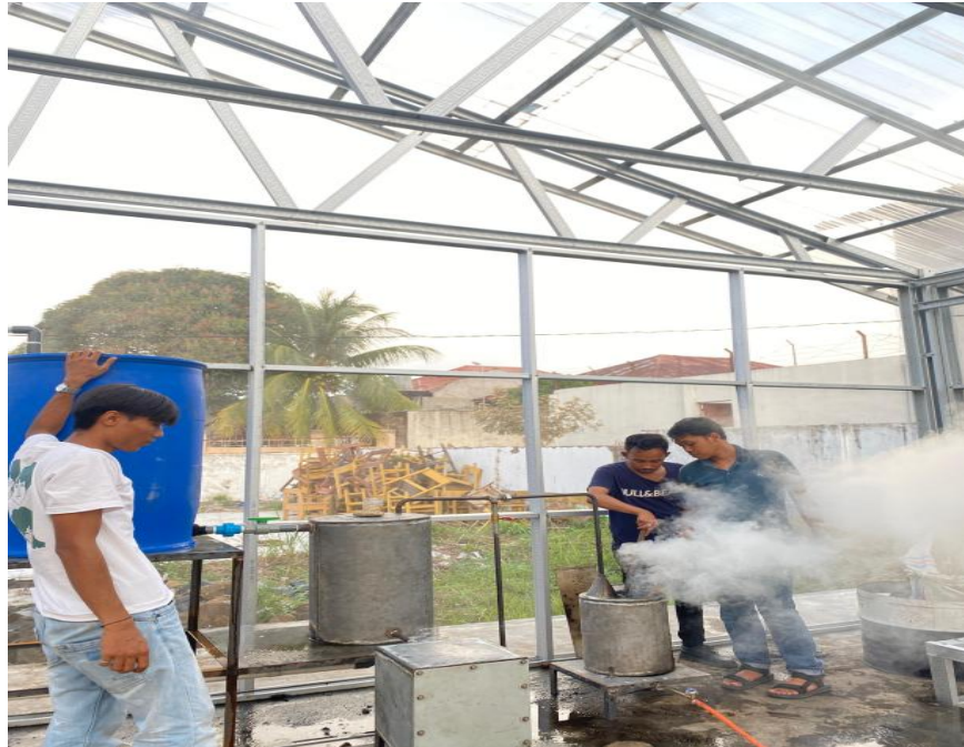
Gambar 2. Proses Pembakaran Pelepah Kelapa Sawit Menjadi Biochar
