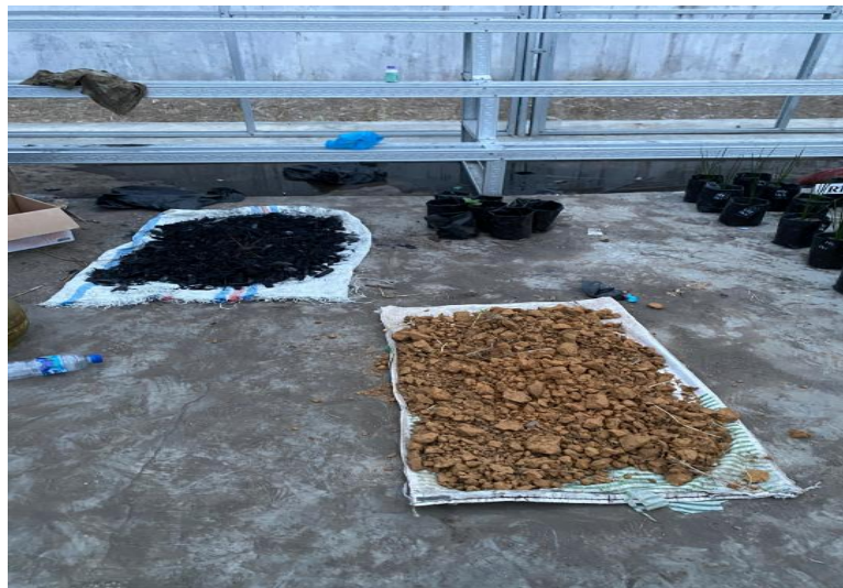
Gambar 3. Hasil Pembakaran Pelepah Kelapa Sawit Menjadi Biochar
