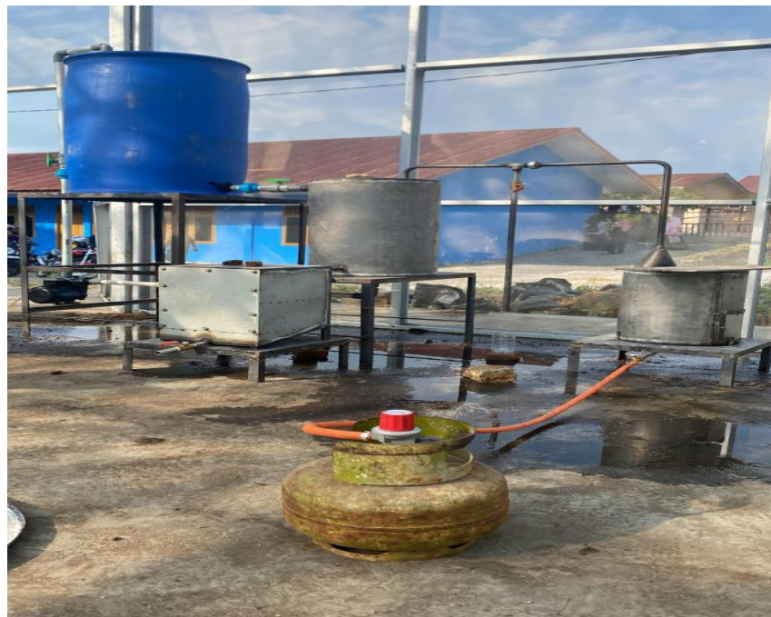
Gambar 1. Alat Pirolisis yang Digunakan Untuk Membakar Biochar
